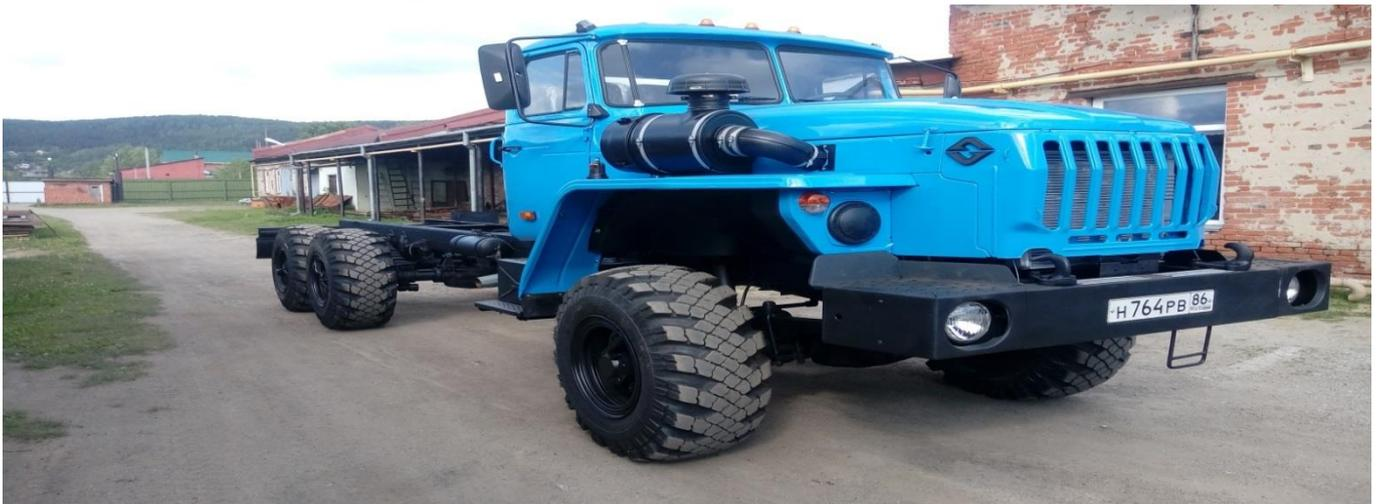
Dimensions hors tout du châssis Ural-4320 : Longueur - 7,588 m ; Largeur - 2,5 m, Hauteur - 2,785 m, Base - 3,525+ (1,4) m. Des modifications d'une longueur raccourcie - 7,388 m sont également produites ; et allongé - 7,921 m. et 9,545 m. Poids à vide - de 8 à 8,7 tonnes ; le poids de la cargaison transportée - 7, 10, 12 tonnes, selon la modification. Répartition de la charge du véhicule équipé : sur l'essieu avant - 4 550 tonnes, sur le bogie arrière - 3 500 tonnes.
